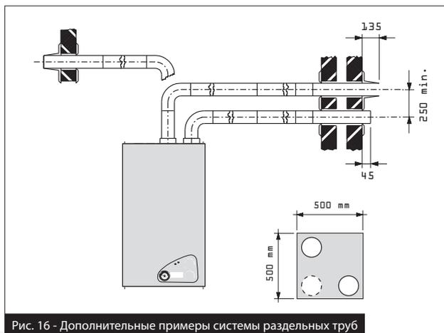
Рис. 16 - Дополнительные примеры системы отдельных труб
