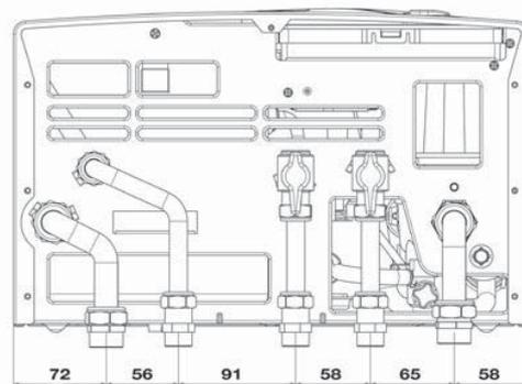
Размеры для подключения гидравлического комплекта "плюс" (опция)
