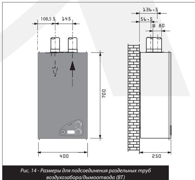
Рис. 14 - Размеры для подключения отдельных труб воздухозабора/дымоотвода (BT)
