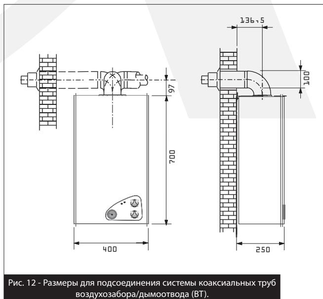
Рис. 12 - Размеры для подсоединения системы коаксиальных труб воздухозабора/дымоотвода (ВТ).
