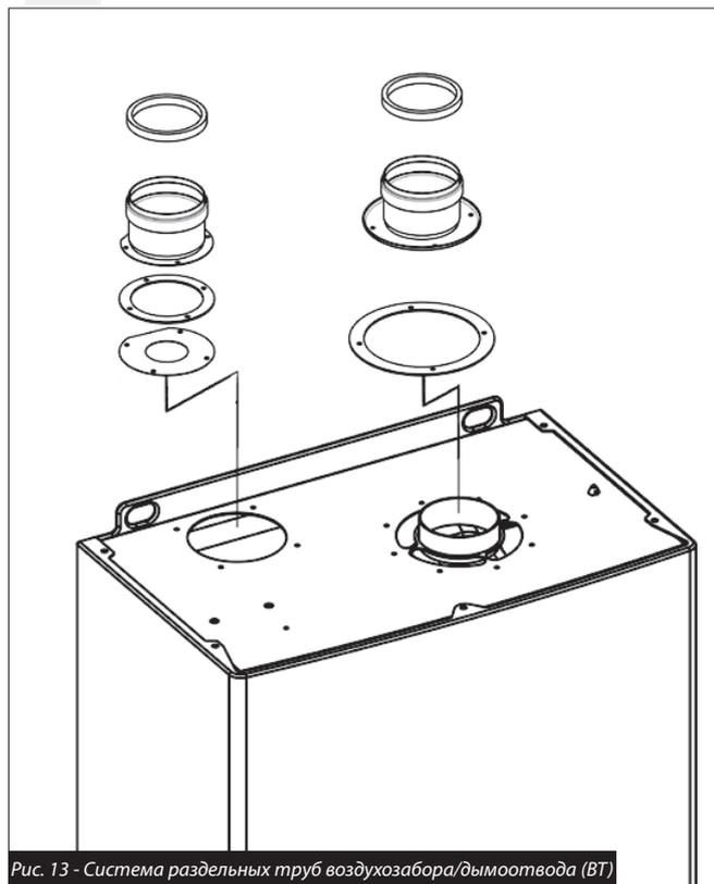
Рис. 13 - Система отдельных труб воздухозабора/дымоотвода (BT)
