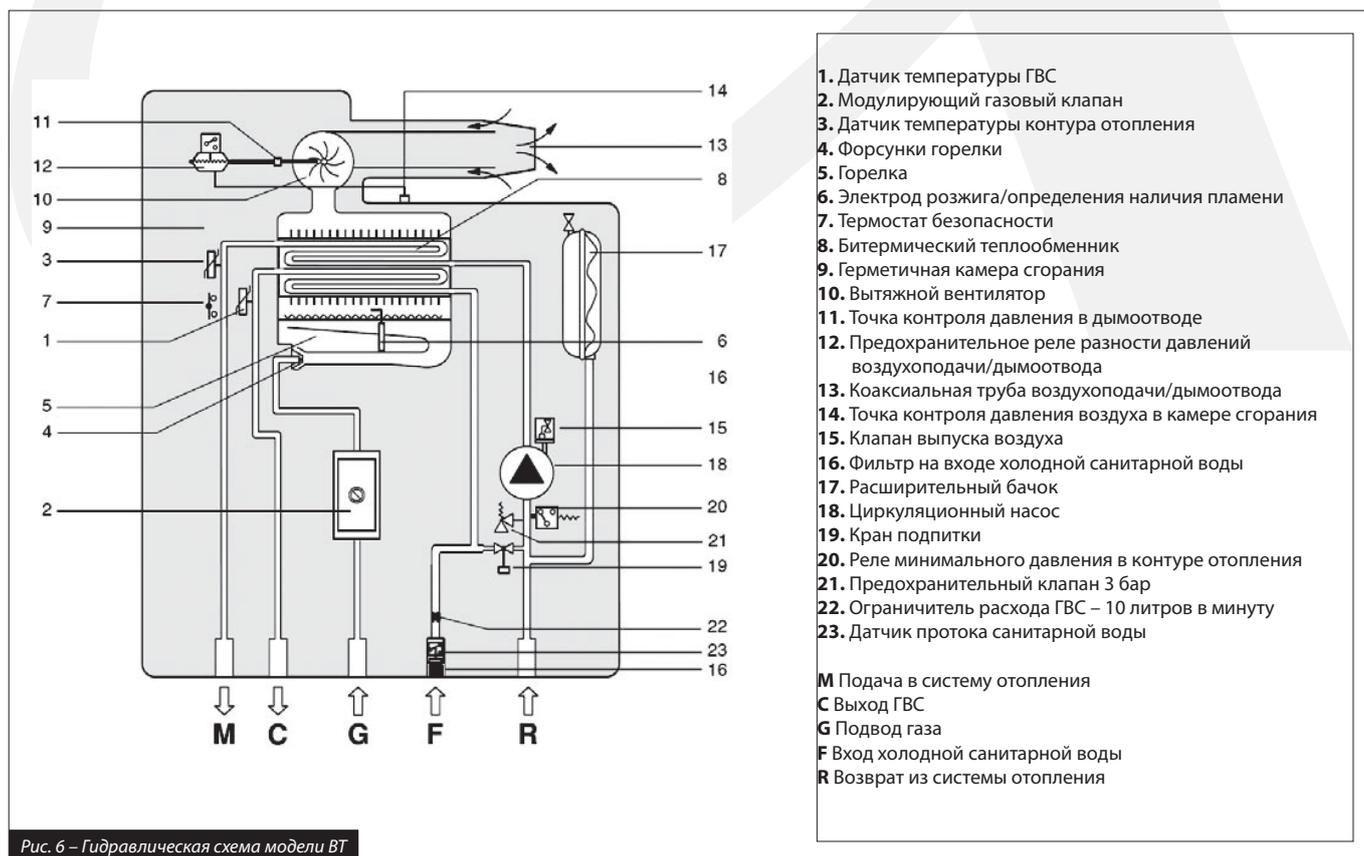
Рис. 6 – Гидравлическая схема модели BT
