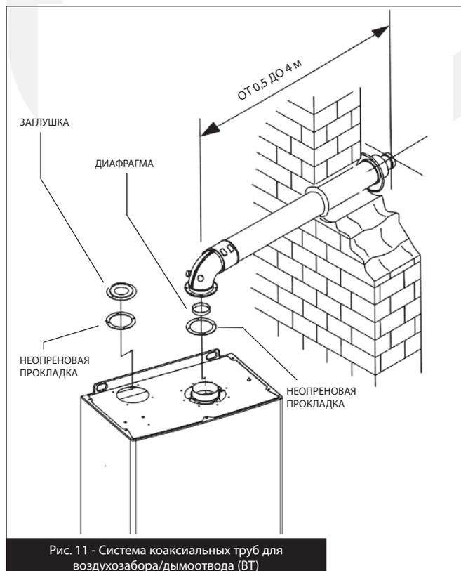
Рис. 11 - Система коаксиальных труб для воздухозабора/дымоотвода (ВТ)
