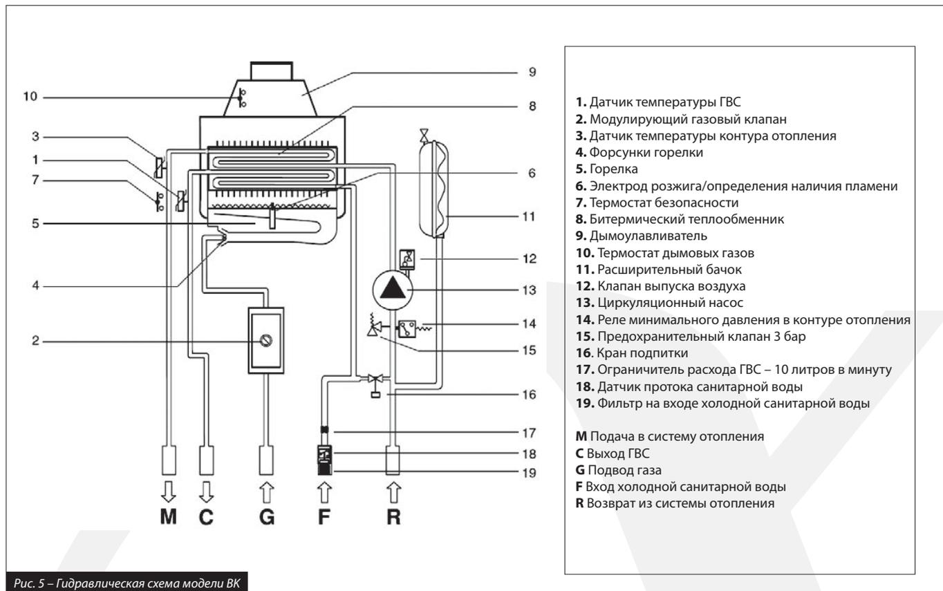
Рис. 5 – Гидравлическая схема модели BK
