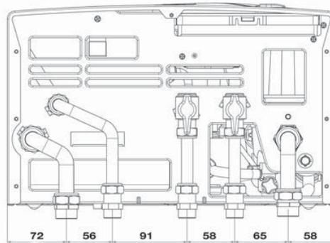
Размеры для подключения гидравлического комплекта "плюс" (опция)
